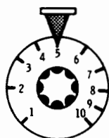
(D) Standard log-taper pot. Dial on pot; pointer on panel.
